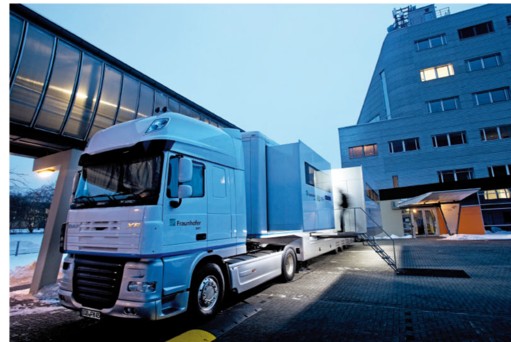
Forschen auf Rädern: Der 14 Meter lange Auflieger des Fahrzeugs lässt sich auf doppelte Breite ausfahren.
