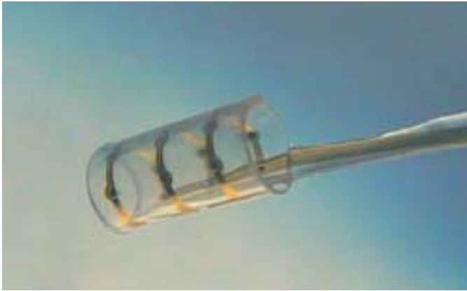
Abbildung 2: Manschetten-Elektrode aus Polyimid mit Verstärkung aus Silikon. Bauform mit 18 integrierten Elektroden. Anwendungsszenario: Schnittstelle zu peripheren Nerven ohne Traumatisierung des Nerven.
