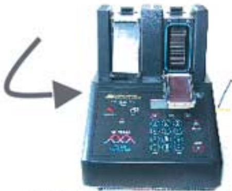
MJ Research ThermoCycler, ausgestattet mit einem „in-situ-Hybridisierungsturm“ zur gesteuerten Temperierung von Objektträgern
