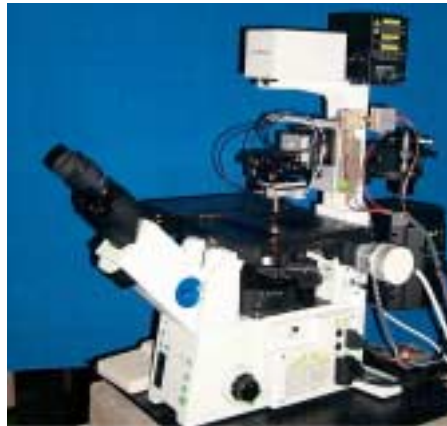
Abb. 2: Photo des akustischen Mikroskops montiert auf ein invertiertes optisches Mikroskop. Dabei wird durch eine rotierbare Säule entweder der Kondensator oder das akustische Mikroskop eingeschwenkt.
