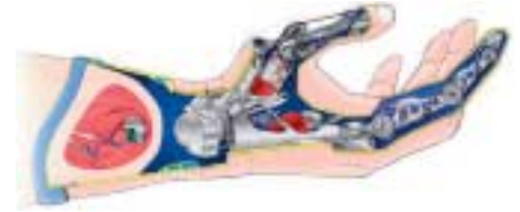
Abb. 1: Schemazeichnung einer kybernetischen Handprothese (Quelle: Cyberhand, SSSA-ARTS & MITECH LABS, Prof. Paolo Dario und Mitarbeiter, Pisa, Italien). Die CYBERHAND System besteht aus den folgenden Komponenten: Siebelektroden zur Kontaktierung afferenter und efferenter Nerven; einem implantierbaren System zur Neurostimulation (um dem Patienten sensorische Rückkopplung zu geben) und zur Ableitung (um den Patientenwillen zum Greifen zu detektieren); einer Telemetrieinheit zur Übertragung afferenter und efferenter Signale; einer biologisch inspirierten mechatrischen Hand mit biomimetischen Signalen; einer externen Einheit zur Detektion des Patientenwillens und zur Prothesensteuerung; einem System zur Erzeugung einer kognitiven Rückkopplung für den Patienten.
