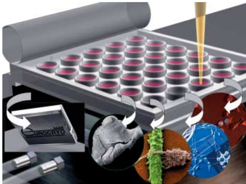
Abb.2.: Neues, miniaturisiertes Kryosubstrat zur Ablage von zellulären Proben aller Art (z.B. suspendierten Zellen, biohybriden Systemen, adhärenente Zellen und Geweben, Implantaten, siehe Einfügungen von rechts nach links). Absolute Verwechslungssicherheit der Proben gewährleistet die Kopplung der Proben mit einem Speicherchip, der mit den Zellen eingefroren wird.
