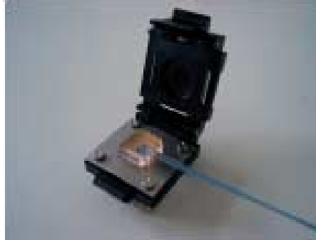
Abb. 4: Testsocket für optoelektronischen Biochip. Aufgesetzt ist ein Fluidikmodul aus Silikon mit Zu- und Abfluss.
