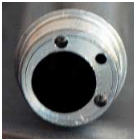
Abb. 2: Querschnitt eines Haltekörpers von der Firma Bosch für das Einspritzventil eines Dieselmotors. Links: Blick auf die Stirnseite mit verschiedenen Bohrungen. Rechts: Blick auf einen Längsschnitt eines in der Mitte aufgeschnittenen Haltekörpers mit den markierten Restwandstärken.
