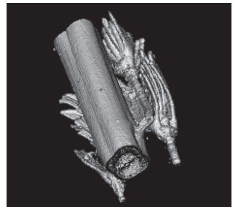
Abb.3: 3D-NMR Image eines wasserbefüllten Zweiges.
