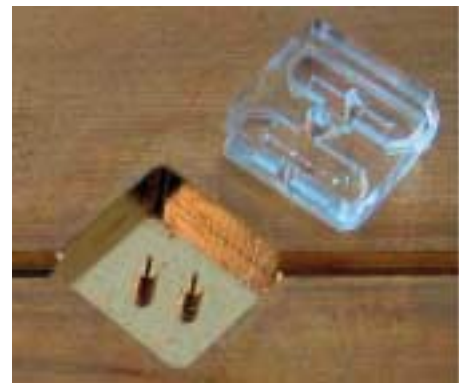
Abb. 2: Oberteil einer Form zum Silikonabformen. Daneben: abgeformtes Mikrofluidikmodul aus Silikon (PDMS).
