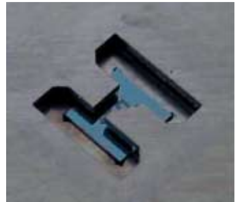
Abb. 1: Unterteil einer Form zum Silikonabformen. Als Formeinsatz dient ein Siliziumplättchen mit photostrukturiertem SU8-Lack.
