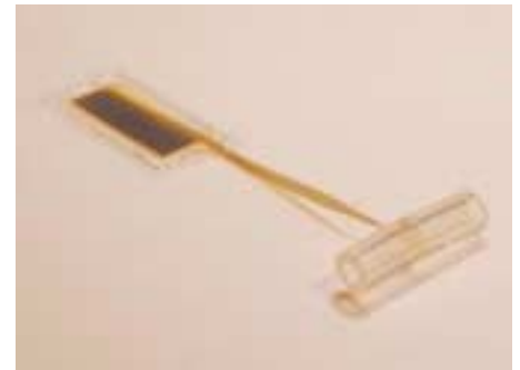
Abb. 2: Siebelektrode aus Polyimid mit Führungskanälen aus Silikon. Bauform mit 19 integrierten Elektroden. Anwendungsszenario: Schnittstelle zu peripheren Nerven nach Amputationsverletzung.
