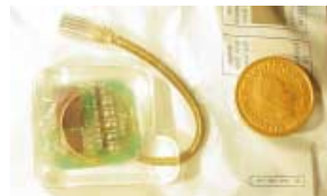
Abbildung 2: Stimulator-Implantat in Sterilbeutel im Größenvergleich mit Münze (10 dänische Kronen).
