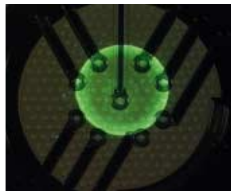
Abbildung 1: Neuronenmikrosonde (oben) sowie Vergrößerung dieser bioelektronischen Mikrostruktur mit positionierter genmanipulierter (GFP, green fluorescent protein) 3D-in-vitro Netzhaut (unten).
